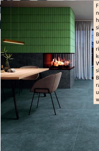
Fußbodenheizungen arbeiten mit niedrigeren Vorlauftemperaturen als herkömmliche Heizkörper und lassen sich mit Sanierungslösungen für den Bestand sogar ohne neuen Estrich umsetzen. Optimales Belagsmaterial auf der Fußbodenheizung sind keramische Fliesen. Durch ihre hohe Wärmeleitfähigkeit transportieren sie die Heizwärme verlustarm an die Bodenoberfläche, wodurch Temperaturänderungen im Raum schneller umgesetzt werden. Infos: [www.deutsche-fliese.de](http://www.deutsche-fliese.de).
